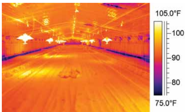
תמונה מס' 2: צד לול המחומם על ידי מקרנים (טמפרטורה רצויה - 33.3^{\circ}\text{C} = 92^{\circ}\text{F} )
