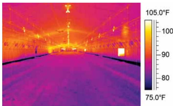
תמונה מס' 1: צד לול המחומם על ידי תנורי חלל (טמפרטורה רצויה - 33.3^{\circ}\text{C} = 92^{\circ}\text{F} )
